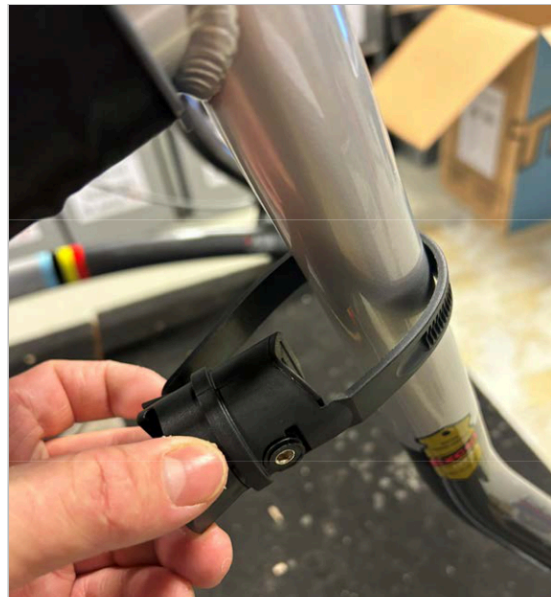
④ 将带子缠绕在 Veloped 后垂直车架管上（在 Walker 助行车上，为半垂直车架管）。
