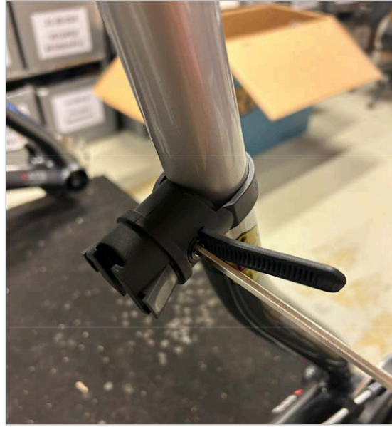
⑥ 使用 4 毫米内六角扳手拧紧螺丝/带子，直到带子绷紧为止。
