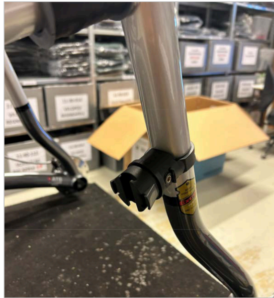
⑧ 照片显示了支架的正确安装。
