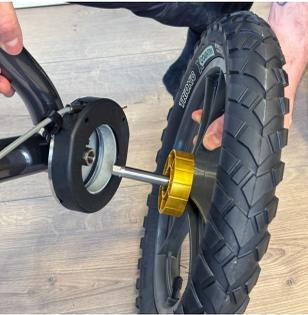
2. 向侧面拉/推轮子以检查轮子是否已正确安装。
