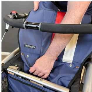
1. 握住座套，Trionic文字位于右侧。将较宽的一侧包裹于伸缩撑杆和座椅底座之间。
