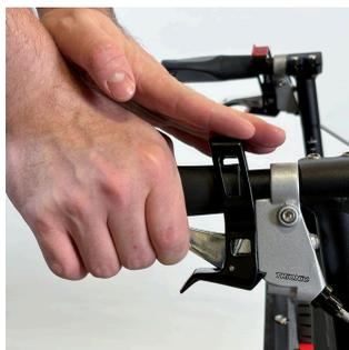
**选项 3:** 双手使用。用一只手向后拉动上方的红色驻车扳机，同时用另一只手拉动制动杆。确保驻车制动器已启用。
