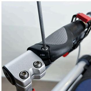
1. 用4毫米内六角扳手松开手柄后端的螺丝。
