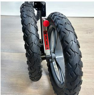
3. 向下或向上滑动调节器（右侧方向）时，务必将调节器滑动至其最底部或最顶部位置。
