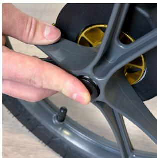
安装车轮时，按下车轮中心的黑色按钮，然后将轮轴推入轴孔中。将轮子推到底，然后松开按钮。
