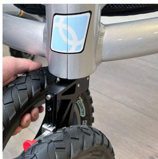
安装前轮悬架时，抬起车架前端，按下黑色按钮，将轮轴推入车架下方的轴孔中。然后松开黑色按钮。将车架前端抬离地面，然后向下拉动车轮悬架，检查前轮悬架是否已经固定。
