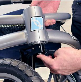
4. 将车架提离地面，向下拉动前轮，检查前轮是否已经固定。
