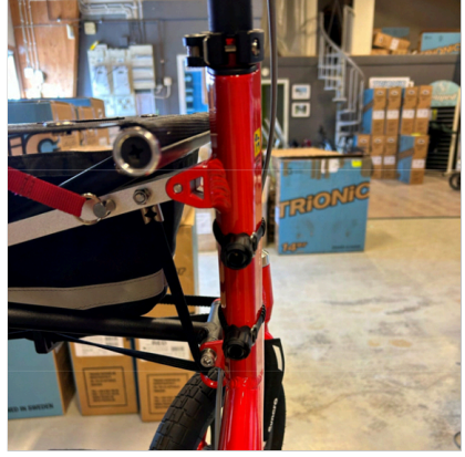
⑥ İki tutucu çerçeve borusuna doğru şekilde monte edilmiştir.
