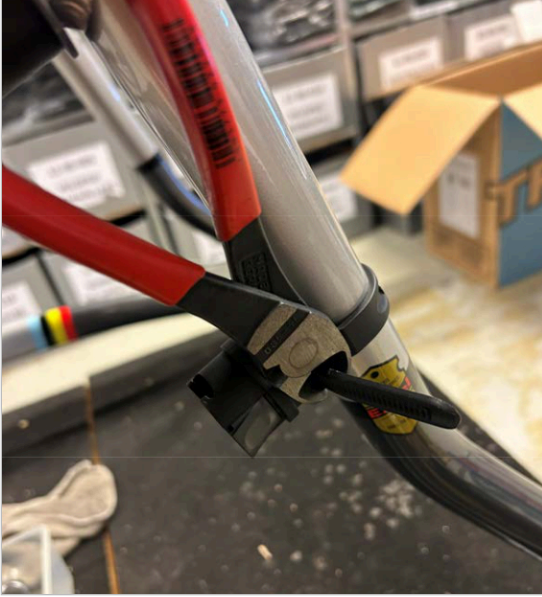
⑦ Kayışın fazla uzunluğunu kablo kesici veya bıçak yardımıyla kesin.
