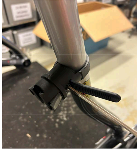
⑥ Kayış sıkılaşına kadar 4 mm'lik alyan anahtarıyla vidayı/kayı sıkın.
