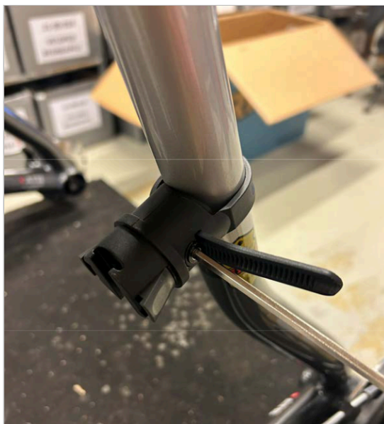
⑥ Vijak/trak privijte s 4 mm imbus ključem, dokler trak ni tesen.
