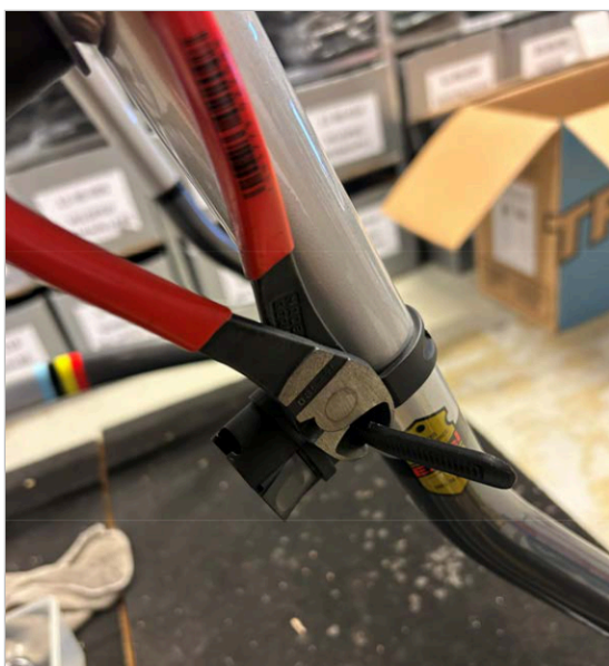
⑦ Odvečno dolžino traku odrežite z rezalnikom za kable ali nožem.
