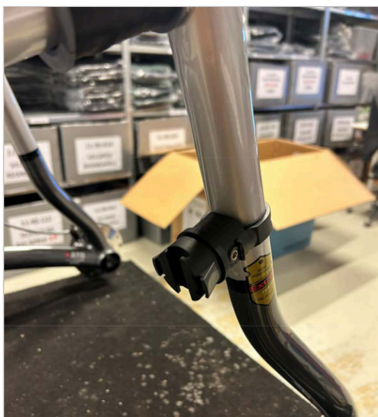
⑧ Fotografija prikazuje pravilno pritrditev nosilca.
