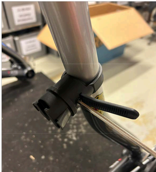
⑥ Skrutku/pásik utiahnite 4 mm imbusovým kľúčom, kým nie je pásik pevne utiahnutý.
