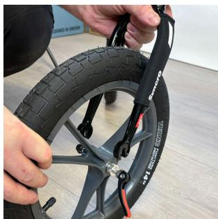
1. Вставьте переднее колесо в вилку, установив быстросъемный рычаг на внешней стороне Walker.
