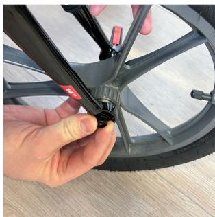
2. Затяните гайку на внутренней стороне вилки так, чтобы при закрытии быстросъемник правильно натянулся.
