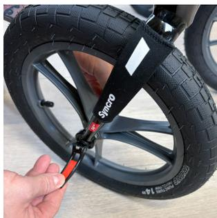
3. Закройте быстросъемный фиксатор на переднем колесе, сложив его внутрь. Убедитесь, что эксцентриковый зажим правильно закрыт, предпочтительно в положении за вилкой, если смотреть в направлении движения Walker.
