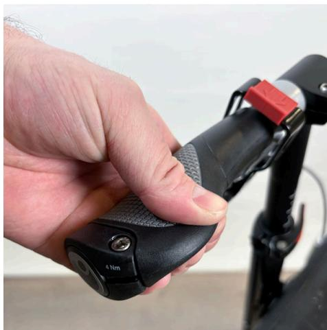
2. Поверните рукоятку, выбрав желаемый угол наклона и зафиксируйте её, снова затянув винт.
