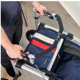
Убедитесь, что Veloped зафиксирован в режиме ходьбы. Для этого, при установке роллатора, вы должны услышать щелчок от телескопической (горизонтальной) стойки, фиксирующейся в нужном положении.
