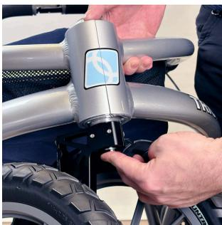
3. Прикрепите подвеску переднего колеса к переднему нижнему концу рамы таким же образом, т. е. нажмите чёрную кнопку в нижней части оси и вставьте ось в отверстие для оси снизу. Отпустите кнопку.
