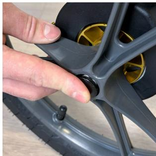
Чтобы прикрепить колесо, нажмите чёрную кнопку в центре колеса и протолкните ось колеса в отверстие для оси. Отпустите кнопку, когда колесо достигнет своего конечного положения.
