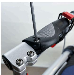
3. Затяните винт на задней части рукоятки шестигранным ключом на 4 мм.
