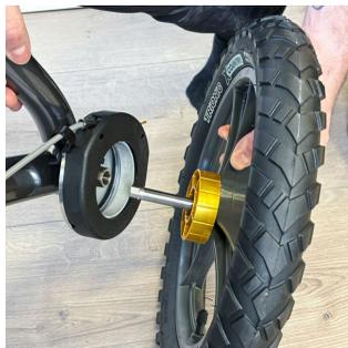
Задние колёса являются съёмными, что значительно упрощает транспортировку Veloped.
