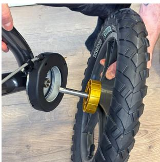
2. Проверьте правильность крепления колёс, потянув каждое колесо то в одну, то в другую сторону.
