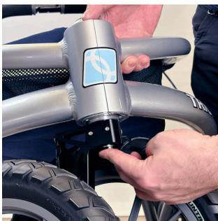
4. Убедитесь, что переднее колесо надёжно закреплено, приподняв раму роллатора и потянув вниз переднее колесо.
