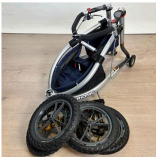
1. Прикрепите задние колёса к отверстиям задней оси рамы, нажав чёрную кнопку в центре колеса, а затем вставив ось до упора в отверстие для оси. Отпустите кнопку.
