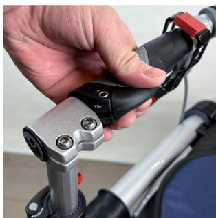
2. Поверните рукоятку, выбрав желаемый угол наклона.
