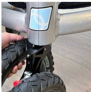
Чтобы установить подвеску переднего колеса, приподнимите переднюю часть рамы, нажмите чёрную кнопку и вставьте ось колеса в отверстие для оси, расположенное под рамой. Затем отпустите чёрную кнопку.
