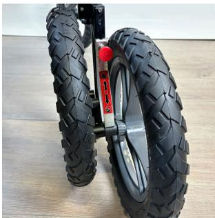
1. Поверните переднее колесо на 180 градусов для облегчения доступа к ручке регулировки.
