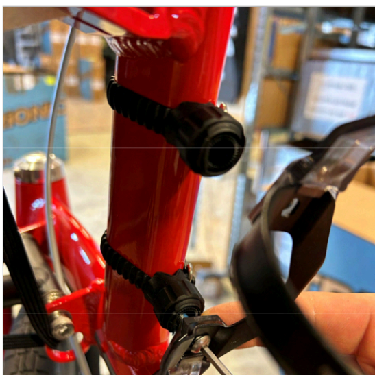
⑦ Fixați suportul pentru sticle cu cele două șuruburi. „Deschiderea” suportului pentru sticle trebuie să fie orientată spre exterior.
