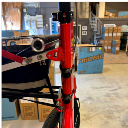
⑥ Cele două suporturi asamblate corect pe țeava cadrului.
