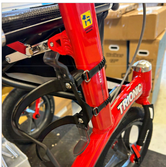
⑧ Suportul pentru sticle este acum atașat la cadru, iar sticla se introduce din lateral și se scoate spre exterior.
