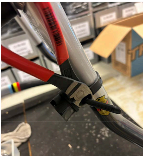
⑦ Tăiați lungimea excesivă a curelei cu un tăietor de cabluri sau cu un cuțit.
