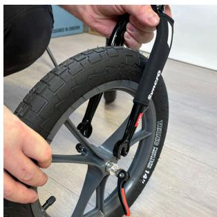
1. Introduza a roda dianteira no garfo, com a alavanca posicionada no exterior do Andador.
