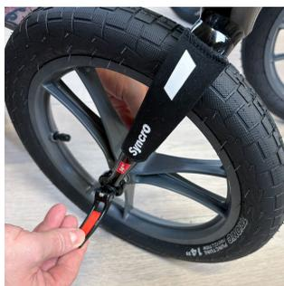
3. Trave a alavanca na roda dianteira, dobrando-a para dentro. Certifique-se de que a alavanca do está corretamente travada, de preferência numa posição atrás do garfo, quando vista na direção de marcha do Andador.
