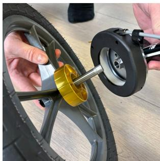
2. Para fixar novamente a roda traseira a estrutura, pressione o botão de aço e deslize a roda sobre o eixo.
