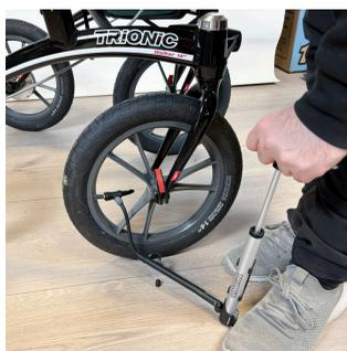
Verifique a pressão de ar dos pneus regularmente. A Trionic recomenda uma pressão de ar nos pneus de 1,5 a 2,0 bar.
