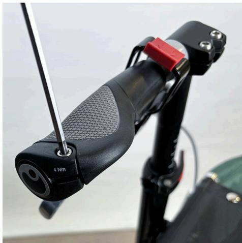
1. Solte o parafuso na extremidade traseira do punho com uma chave Allen de 4 mm.
