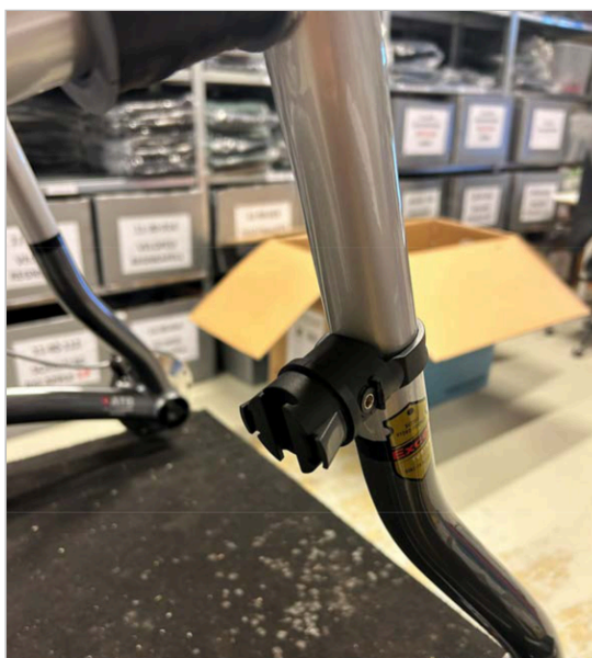
⑧ A foto mostra a fixação correta do suporte.
