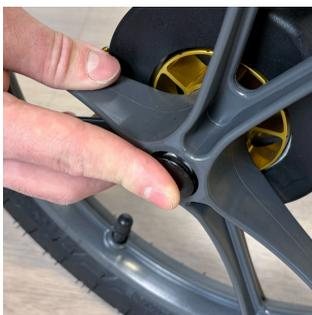
Para fixar a roda, pressionar o botão preto no centro da roda e empurrar o eixo da roda para o orifício do eixo. Soltar o botão quando a roda estiver na sua posição final.
