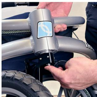
3. Fixar a suspensão da roda dianteira à extremidade inferior dianteira do quadro da mesma maneira, ou seja, pressionar o botão preto no fundo do eixo e pressionar o eixo no orifício do eixo por baixo. Soltar o botão de pressão.
