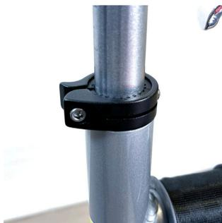
**NOTA!** Não acionar as alavancas de aperto como porcas de asa ou parafusos. As alavancas de aperto podem ser substituídas por parafusos e porcas se houver o risco de o utilizador soltar acidentalmente as alavancas enquanto utiliza o Veloped.
