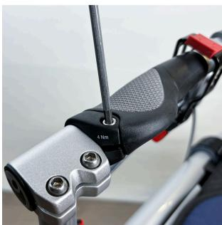
3. Aperte o parafuso na extremidade traseira do punho com uma chave Allen de 4 mm.
