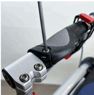
1. Desaperte o parafuso na extremidade traseira do punho com uma chave Allen de 4 mm.
