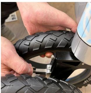
2. Pegue na roda esquerda com a mão esquerda e levante a extremidade frontal do Veloped ligeiramente do chão.
