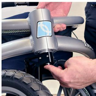
4. Verificar se a roda dianteira está bem presa levantando a estrutura da superfície e puxando a roda dianteira para baixo.
