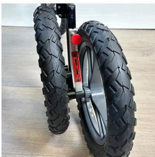
1. Girar a roda dianteira 180 graus para facilitar o acesso ao punho de ajuste.
