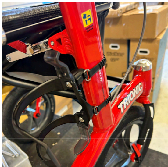
⑧ Uchwyt na butelkę jest teraz przymocowany do ramy. Butelkę wkłada się z boku i wyjmuje na zewnątrz.
