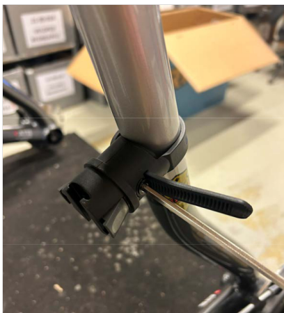
⑥ Dokręć śrubę/pasek kluczem imbusowym 4 mm, aż pasek będzie dobrze napięty.
