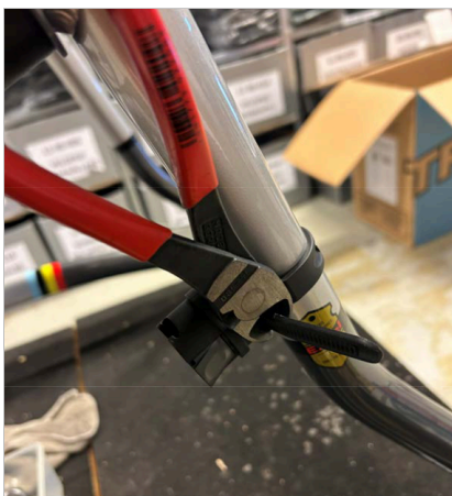
⑦ Nupjaukite perteklinį dirželio ilgį kabelių žirkėmis arba peiliu.
