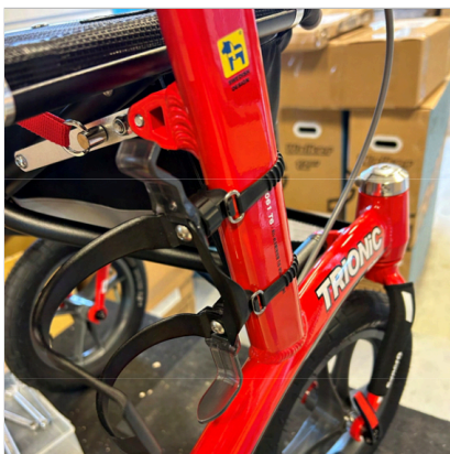
⑧ A palacktartó most a kerethez van rögzítve, oldalról kell behelyezni a palackot, majd kifelé kivenni.
