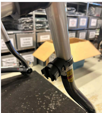
⑧ A képen a tartó helyes rögzítése látható.
