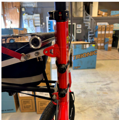
⑥ Dva držača ispravno sastavljena na cijevi okvira.
