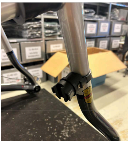
⑧ Fotografija prikazuje ispravno pričvršćivanje nosača.
