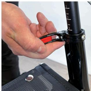
1. Desserrer l'anneau de verrouillage rapide situé juste au dessus du siège en le dépliant vers l'extérieur horizontalement.
