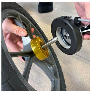
2. Pour fixer la roue, appuyez sur le bouton noir au centre de la roue et poussez l'axe de la roue dans le trou de l'axe. Relâchez le bouton lorsque l'axe est en position finale.
