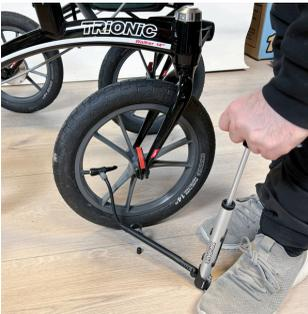
Vérifiez régulièrement la pression d'air des pneus. Trionic recommande une pression de 1,5 à 2,0 bars.
