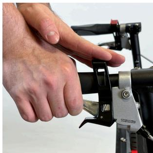
**Option 3 :** Utilisez les deux mains. Tirez vers l'arrière le mécanisme de verrouillage supérieur de couleur rouge avec une main, en tirant simultanément avec l'autre main sur la poignée de frein. Assurez-vous que le mécanisme de verrouillage soit bien enclenché.
