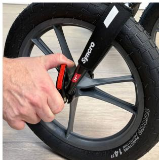
1. Ouvrir le mécanisme de déverrouillage rapide de la roue avant en le dépliant vers l'extérieur.
