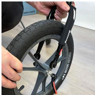
1. Introduisez la roue avant sur la fourche, le mécanisme de déverrouillage rapide étant déplié vers l'extérieur du Walker.
