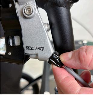
1. Si les freins fonctionnent mal, desserrez la vis de réglage de chaque levier de frein (dans le sens inverse des aiguilles d'une montre) et bloquez-la en position en vissant l'écrou de blocage vers la poignée (dans le sens des aiguilles d'une montre).
