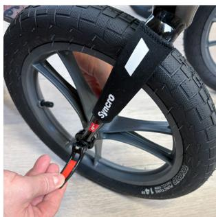
3. Fermez le mécanisme de déverrouillage rapide sur la roue avant en le repliant vers l'intérieur. Assurez-vous que le mécanisme de verrouillage rapide soit correctement fermé, de préférence derrière la fourche, comme vous pouvez le voir sur le visuel ci-dessus.
