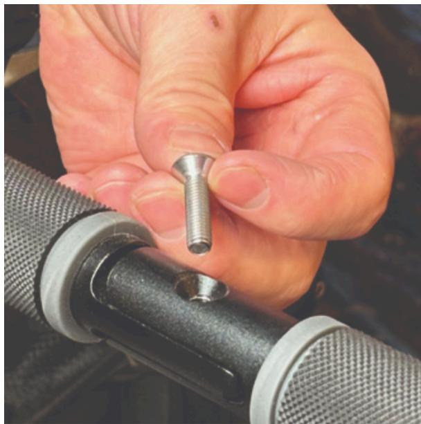
**A1.** Localisez la vis au niveau de la charnière centrale de la barre de préhension en forme de U du Veloped. Dévissez la vis à l'aide de la clé Allen de 4 mm fournie et retirez-la.
