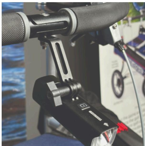
**B7.** Identifiez l'extrémité avant circulaire du porte-lumière, avec deux fentes pour la fixation de la lumière.
