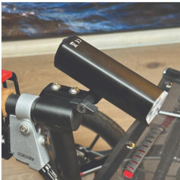
**A7.** Poussez le support fendu de la lumière dans les fentes du support et assurez-vous qu'ils sont alignés. Vu dans le sens de marche du Walker, introduisez l'écrou à ailettes fourni par la gauche et serrez-le.
