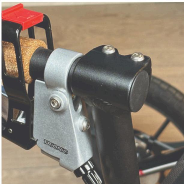
**A1.** Sur le dessus du tube semi-vertical noir, repérez les deux vis qui serrent le tube de la poignée, situé devant le levier de frein.
