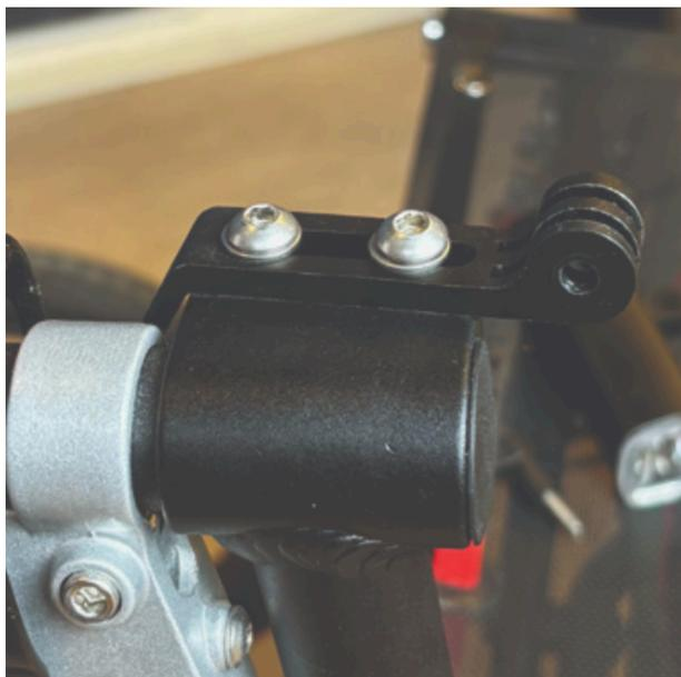
**A6.** Identifiez l'extrémité avant circulaire du porte-lumière, avec deux fentes pour la fixation de la lumière.
