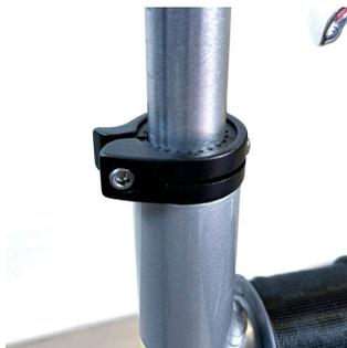
**ATTENTION !** Ne verrouillez pas le guidon en utilisant les anneaux de verrouillage rapide comme un levier papillon ou une vis. Les anneaux de verrouillage rapide peuvent être remplacés par des vis ou des écrous s'il existe un risque que l'utilisateur tire accidentellement sur le levier de l'anneau en utilisant le Veloped.
