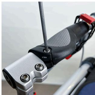
1. Desserrez la vis sur la partie arrière de la poignée avec une clé hexagonale 4 mm.
