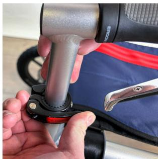
Resserrer les deux anneaux de verrouillage rapide du guidon en les pliant vers l'intérieur.
