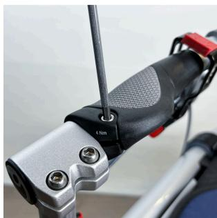
3. Serrez la vis sur la partie arrière de la poignée avec une clé hexagonale 4 mm.
