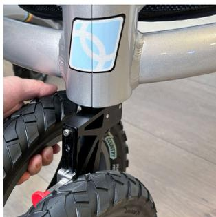
Pour remettre le support de la roue avant : soulevez l'avant du cadre, enfoncez le bouton noir au centre de la roue et enfoncez l'essieu de la roue dans l'orifice sous le cadre. Relâchez le bouton-poussoir noir.
