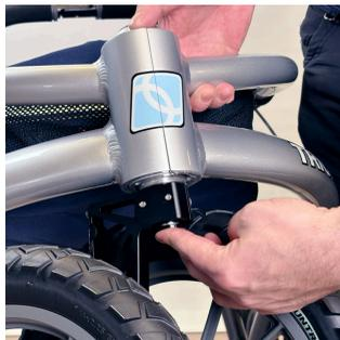
4. Vérifiez que la roue avant soit bien fixée en soulevant le cadre du sol et en tirant le support de la roue vers le bas.
