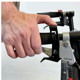
**Option 2 :** Tirez vers l'arrière avec votre pouce le mécanisme de verrouillage supérieur de couleur rouge, en tirant simultanément sur la poignée de frein. Assurez-vous que le mécanisme de verrouillage soit bien enclenché.
