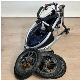
1. Montez les roues arrière sur l'essieu arrière du cadre en enfonçant le bouton noir au centre de la roue, puis en poussant l'essieu entièrement dans l'orifice du cadre. Relâchez le bouton noir.
