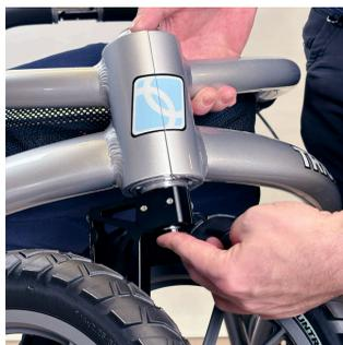
3. Installez de la même manière le support pour la roue avant sur l'avant du cadre, c'est-à-dire en appuyant sur le bouton noir en bas de l'essieu et en enfonçant l'essieu dans l'orifice du cadre par en dessous. Relâchez le bouton-poussoir.
