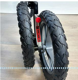
3. Glissez l'ajusteur (main droite) soit vers le bas (mode ville/conduite facile), soit vers le haut (mode tout-terrain/suspension). Il est important de faire glisser l'ajusteur jusqu'à sa position la plus basse ou la plus haute.
