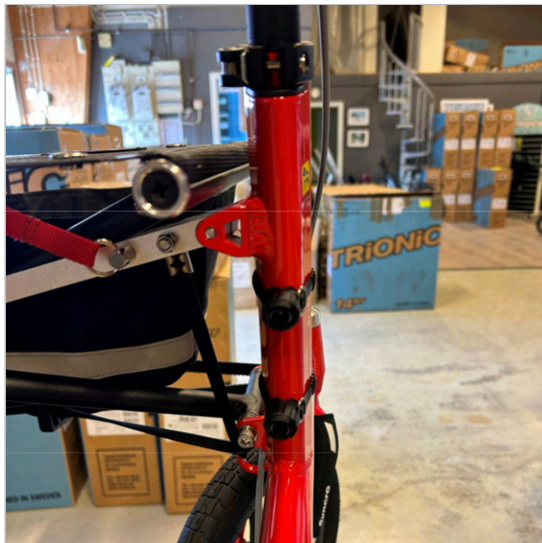
⑥ Kaks hoidikut on raamitorule õigesti paigaldatud.
