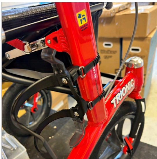
⑧ Pudelihoidja on nüüd raami külge kinnitatud ja pudel sisestatakse küljelt ning eemaldatakse väljapoole.
