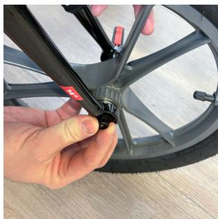
2. Apriete la tuerca en la parte interna de la horquilla para que el mecanismo de desacoplamiento rápido quede correctamente tensado una vez cerrado.
