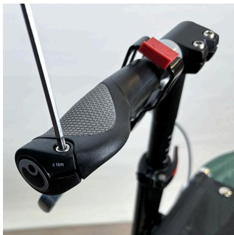
1. Afloje el tornillo de la parte trasera del agarre con una llave Allen de 4 mm.
