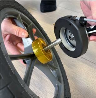
2. Para fijar la rueda, presione el botón negro situado en el centro de esta e introduzca el eje de la rueda en el orificio correspondiente. Suelte el botón cuando el eje esté en su posición final.
