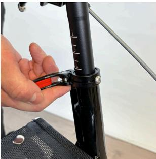
4. Abra las palancas de desacoplamiento/desmontaje rápido y regule la altura de las empuñaduras como se describe en la página 7, en el capítulo “Ajuste de la altura de las empuñaduras”.
