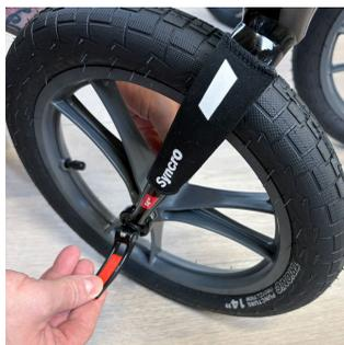
3. Cierre la palanca de desacoplamiento rápido de la rueda delantera, girándola hacia dentro. Asegúrese de que la palanca de desacoplamiento rápido esté bien cerrada y, si es posible, oculta detrás de la horquilla al observarla desde la posición en la que usted se desplaza con su andador Walker.
