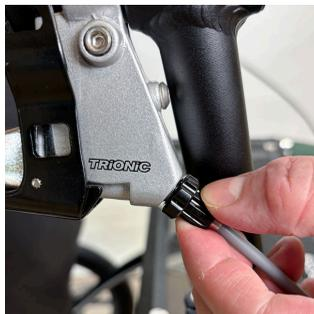
1. Si los frenos no funcionan bien, afloje el tornillo de ajuste en cada palanca de freno (girándolo a la izquierda) y fíjelo en la posición correcta, girando la tuerca de fijación hacia la empuñadura (a la derecha).
