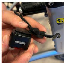
**A3.** Fije la luz al andador, ya sea en el tubo del marco semivertical, justo debajo de la palanca de liberación rápida de ajuste de altura, o en el tubo de agarre semivertical negro. Tire de la correa con fuerza y fíjela con el gancho de plástico.
