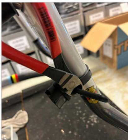
⑦ Κόψτε το υπερβολικό μήκος του ιμάντα με κόφτη καλωδίου ή μαχαίρι.
