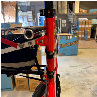
⑥ Dva držáky správně namontované na rámové trubce.
