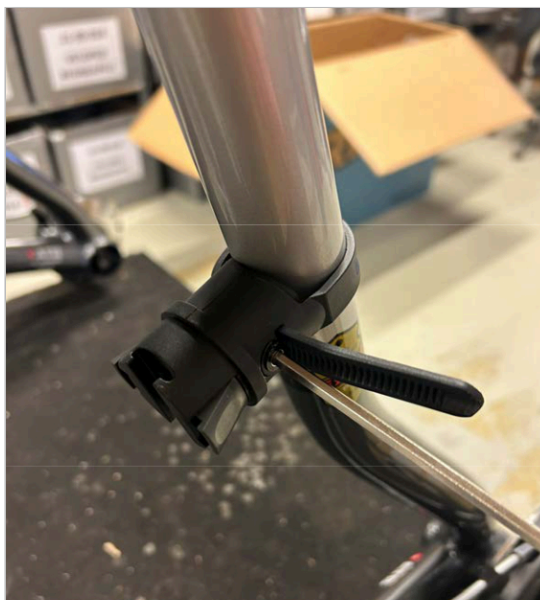
⑥ Utáhněte šroub/pásek pomocí 4mm imbusového klíče, dokud nebude pásek pevně utažený.
