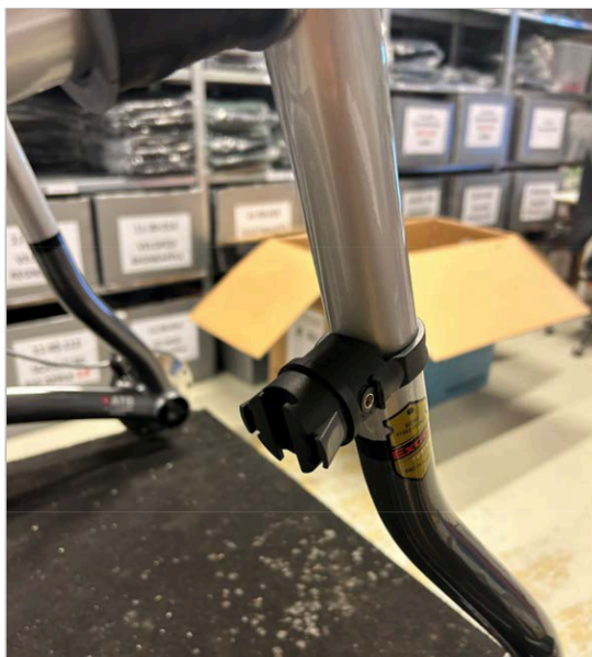
⑧ Fotografie ukazuje správné upevnění držáku.
